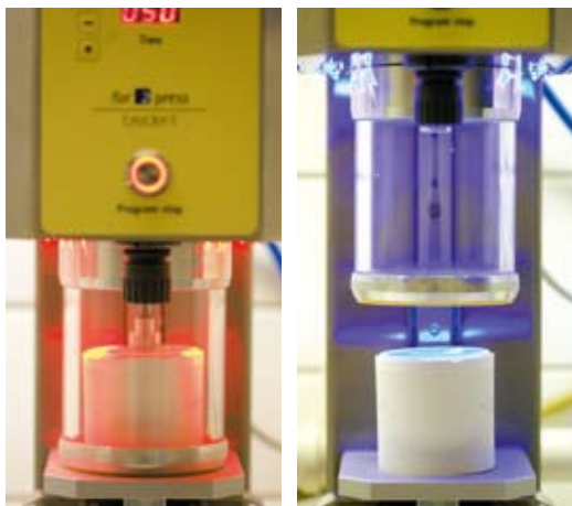
Abb. 8a und b: Der Pressvorgang im Vakuum-Pressgerät. Das BioHPP-Granulat wird in die Muffel gepresst.
